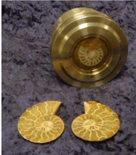
Figura 8: Fotografía de una amonita cortada para DRX.
