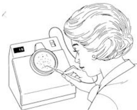
Figura 5.1.4: Cámara cuentacolonia. Extraído de Microbes in action 4ª Ed. A Laboratory Manual of Microbiology. Seeley HW, Vandemark PJ, Lee JJ. 1991.
