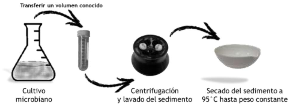
**Figura 21. Esquema para la determinación de peso seco.**
