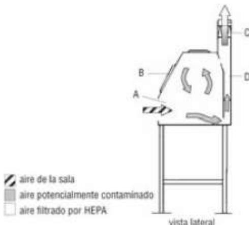
**Figura 1. Esquema de una cámara de seguridad biológica de clase I.**
