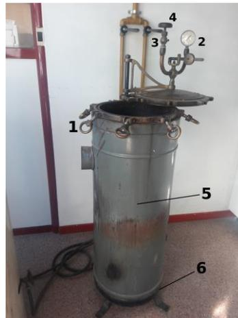
**Figura 4: Autoclave Chamberland: 1) mariposas o charnelas para el cierre hermético, 2) manómetro, 3) espita, 4) válvulas de seguridad, 5) agua, 6) fuente de calor.**
