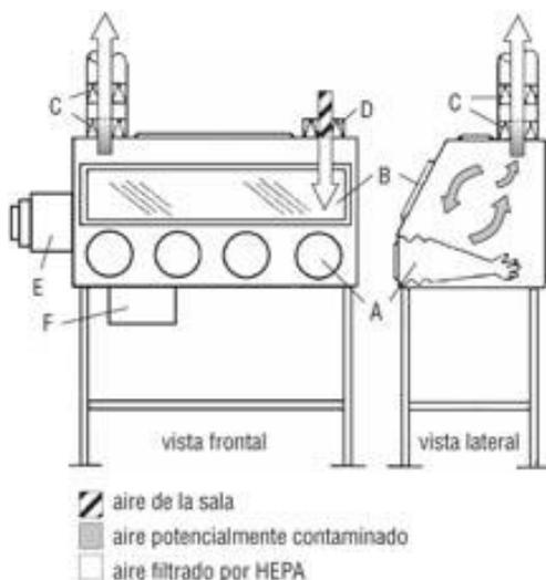
**Figura 3. Esquema de una cámara de seguridad biológica de clase III (cámara de guantes).**
