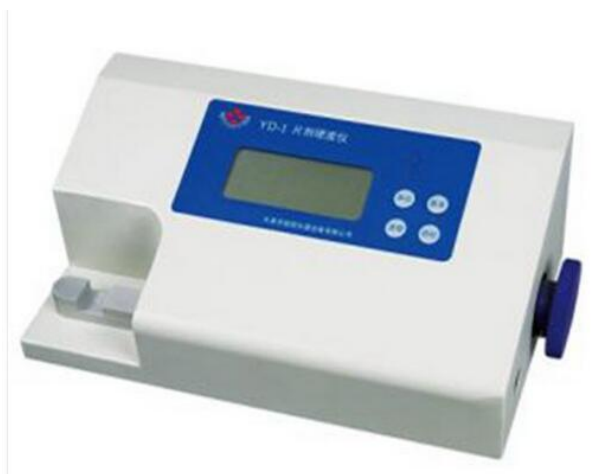
Figura: equipo para determinar dureza en s.
