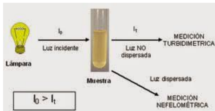
Figura 24. Principio de detección de la turbidimetría y la nefelometría. ( https://www.redalyc.org/articulo.oa?id=181226886003 )
