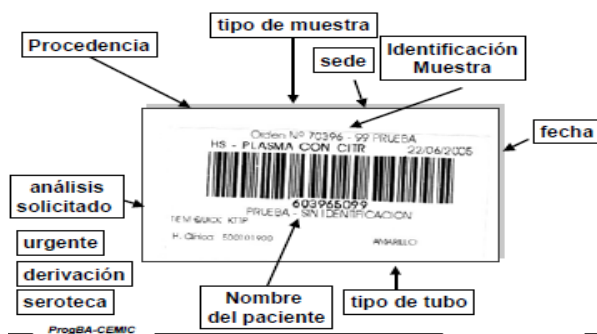
Figura 1. Código de barras para identificar las muestras. Consta de 8 dígitos. Se interpretan de la siguiente manera: los dos primeros corresponden al día de la utilización, los dos siguientes son el mes, los 4 restantes se relacionan con el número de identificación para el laboratorio.
