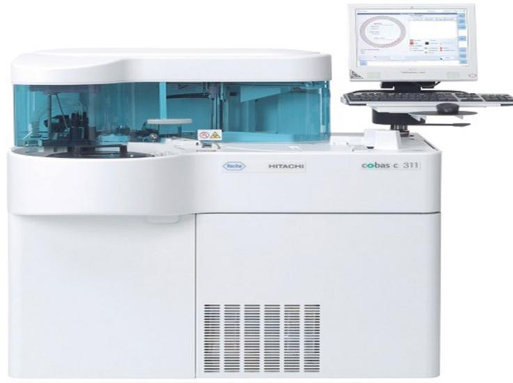
Figura 6. Analizador de Química Clínica Cobas e311 de acceso aleatorio (*random access analysis*) y configuraciones de prioridad STAT flexibles (Roche Diagnostics).
