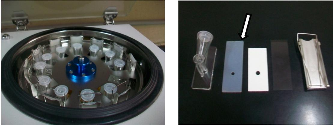
Figura 38. Izquierda: Citocentrífuga cargada con varias muestras. Derecha: set de elementos que se utilizan en cada muestra. La flecha señala el potaobjeto con la zona de sediment concentrada.
