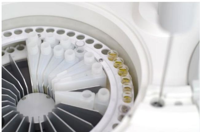
Figura 11. Bandeja de muestras y reactivos autoanalizador CM250 WIENER.
