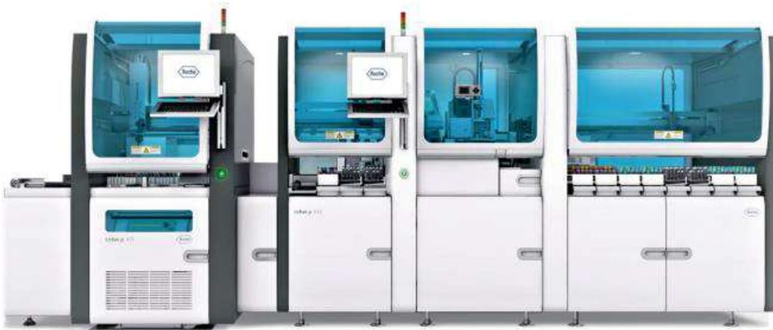
Figura 4. Estación de trabajo extraanalítica multifunción. El equipo Roche Cobas 612 posee un sistema automatizado de centrifugación, destapado y recapsulado de tubos, realización de alícuotas y etiquetado con código de barras de tubos secundarios, incluida la inspección de la calidad de la muestra para descartar hemólisis, lipemia e ictericia (<http://www.cobas.com>).
