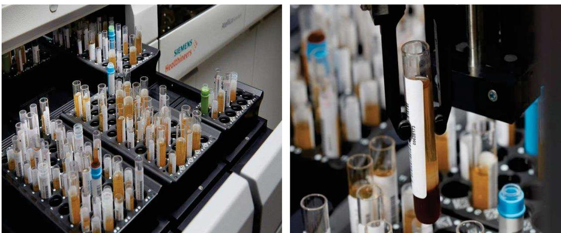
Figura 12. A) Soporte de muestras ATELLICA SIEMENS y B) Brazo mecánico toma tubo para posterior lectura de código de barras y transporte a sector analítico del equipo (<https://www.siemens-healthineers.com/>).
