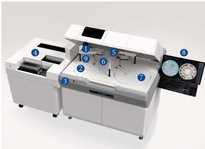
Figura 5. Partes de un autoanalizador 1) Sonda de muestra; 2) Bandeja de muestras; 3) Carga de muestra; 4) Carga y recogida de racks; 5) Unidad de lavado; 6) Cubeta de reacción; 7) Bandeja de reactivos; 8) Interfaz de usuario y 9) Módulo ISE (electrodo ión selectivo) integrado (ClinicalChemistryAnalyzer/CA-800).
