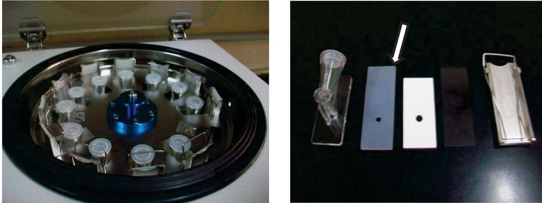
Figura 38. Izquierda: Citocentrífuga cargada con varias muestras. Derecha: set de elementos que se utilizan en cada muestra. La flecha señala el potaobjeto con la zona de sedimento concentrada.
