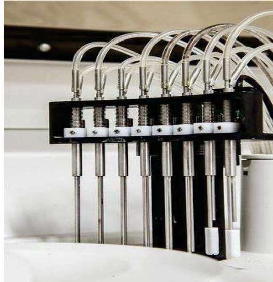
Figura 14. Las estaciones de lavado en un analizador de Química Clínica realizan las siguientes operaciones: (1) aspiran los desechos de reacción y dispensan agua, (2) aspiran y dispensan agua de enjuague, (3) aspiran agua de enjuague y dispensan agua para la medición del blanco y (4) aspiran el agua de la celda blanco para el secado (Roche Diagnostics).
