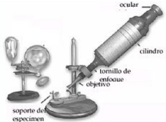
Microscopio utilizado por Hooke en 1665
