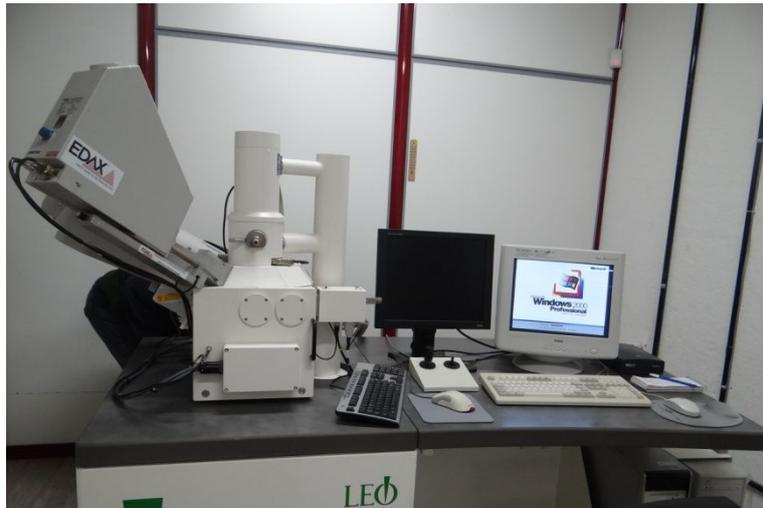
Microscopio electrónico de barrido
