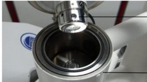
Parte superior del MEB, se observa el cilindro y la columna
