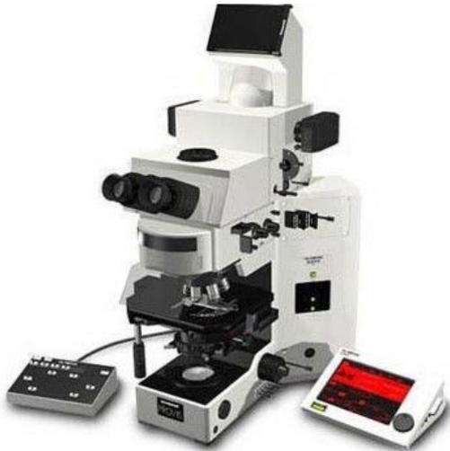
**Microscopio Olympus Provis AX-70** (1998), este modelo contiene accesorios para fluorescencia, luz polarizada, contraste de fase. Se pueden obtener fotomicrografías utilizando varios tipos de film y captura de imagen digital.
